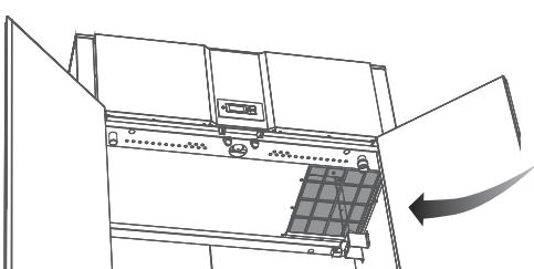
Avlägsna ludd på luddfiltret i taket efter avslutad torkning.
